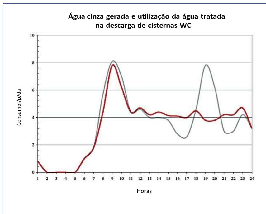
A partir do balanço hídrico, determinam-se os volumes de acumulação da água bruta e da já tratada, assim como os caudais e fluxos de água. O tempo de residência nos depósitos tem que garantir o abastecimento da água reciclada, reduzindo ao máximo o uso de água da rede.
